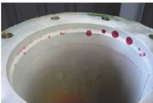
DIE PENETRANT TEST
